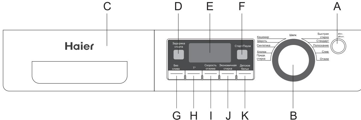
А — кнопка включения или выключения стиральной машины.
